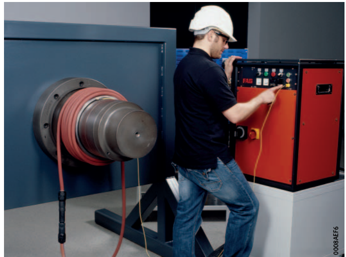
Bild 2 Demontage von Lagerinnenringen mit flexiblem Induktor
