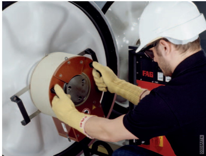
Bild 3 Demontage Lagerinnenringe von Radsatzlagern (Schienen- fahrzeuge) mit Festinduktor
