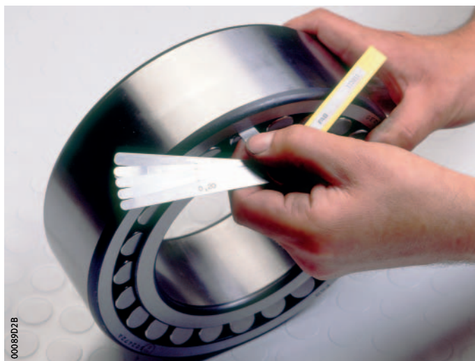
Bild 7 Messen der Radialluft mit Fühlerlehren
